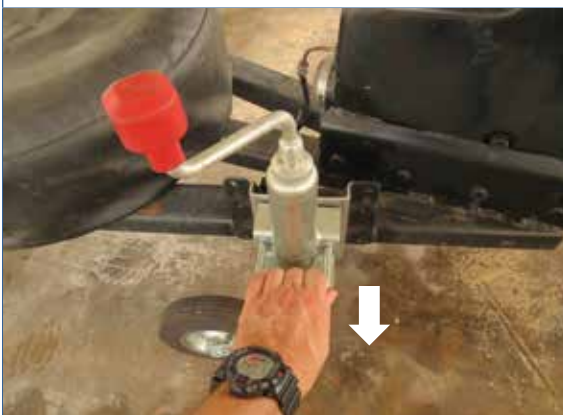
Foto 9. Destravando a sapata com roldana
