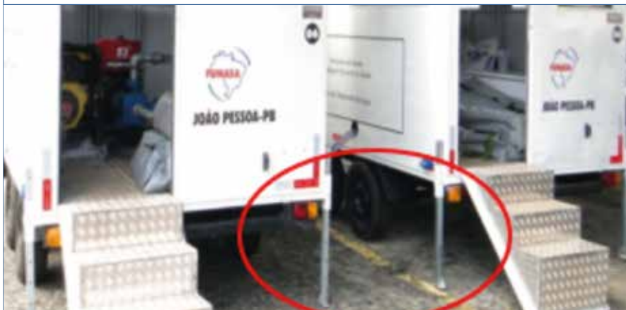
Foto 25. Travamento das sapatas
