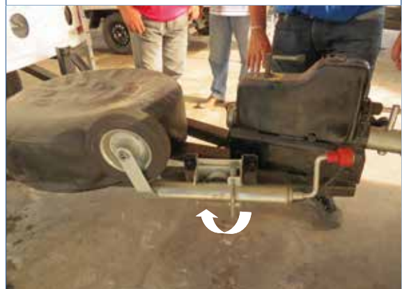
Foto 10. Recolhendo e travando a sapata com roldana
