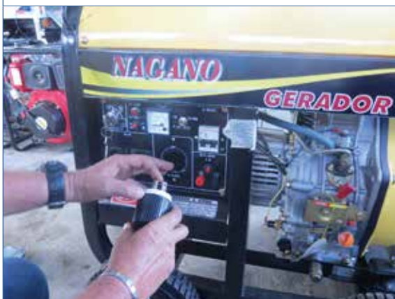
Foto 30. Conectando o cabo de energia
