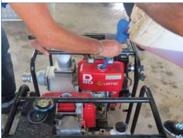
Foto 35. Abastecimento da motobomba
