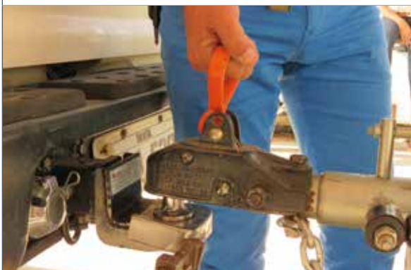
Foto 2. Fixação do engate
