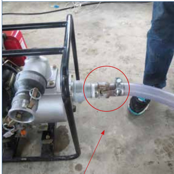
Foto 46. Dispositivo de entrada de água
