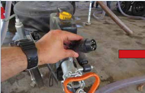
Foto 6. Conectando o sistema elétrico do trailer
