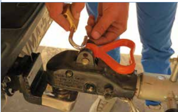
Foto 4. Fixação do travamento do engate
