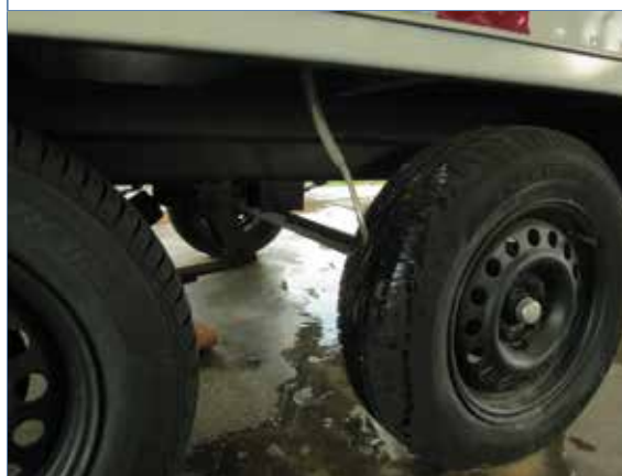
Foto 120. Vazão da água do interior do tanque
