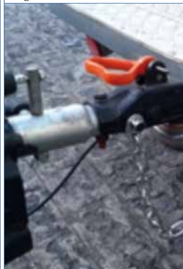
Foto 20. Situação ideal de engate
