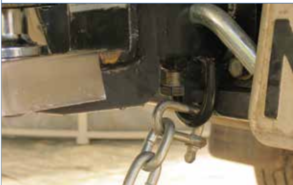
Foto 5. Travamento da corrente de segurança
