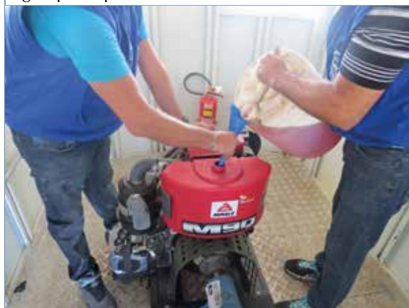
Foto 37. Abastecimento do motor e bomba de água principal
