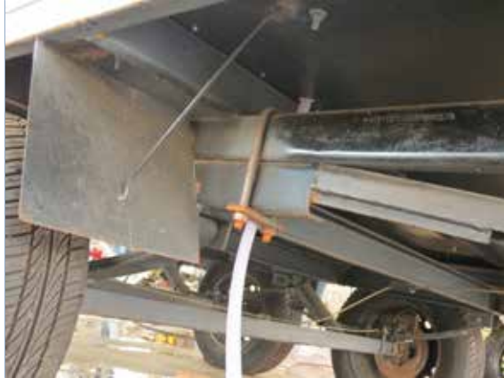
Foto 121. Mangueira de liberação de água do tanque
