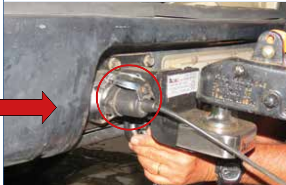
Foto 7. Conectando o sistema elétrico do trailer
