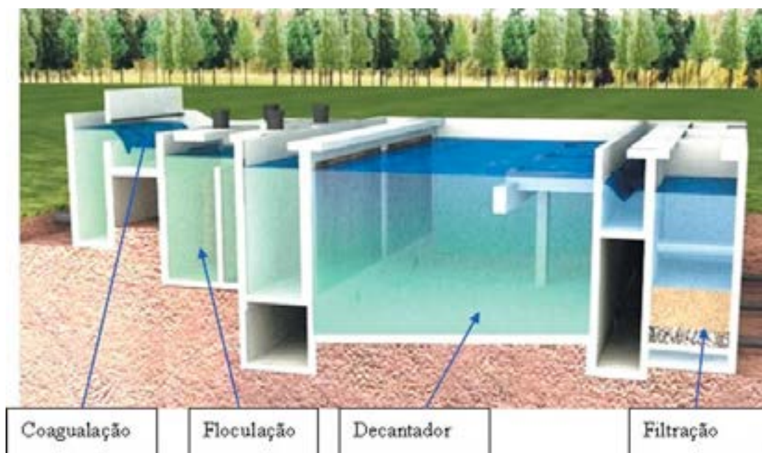
Figura 20 – Desenho esquemático das etapas do tratamento convencional. Fonte: RECESA (2008).
