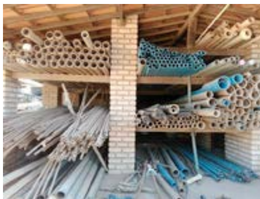
Figura 17 – Estoque de tubos para utilização em sistemas de abastecimento de água em comunidades rurais do estado da Bahia.
