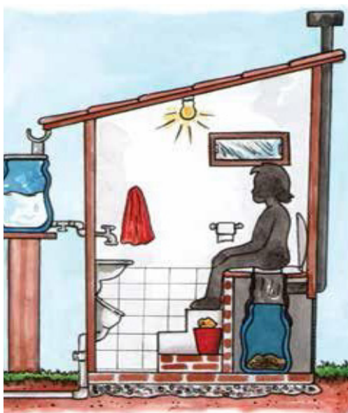
Figura 39 – Ilustração dos primeiros modelos construídos com: recipiente móvel, degraus, mictório abaixo da pia e sem chuveiro. Fonte: Cepagro (2013).
