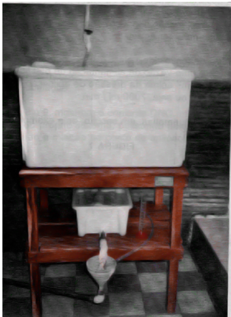
Figura IV – Dosador simples por gravidade e por transporte
