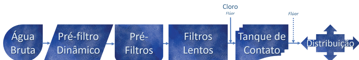
Figura 6 – Fluxograma da filtração em múltiplas etapas. Fonte: os autores.
