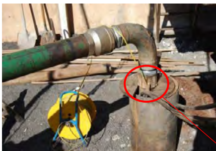
Figura 1 - Vista da parte externa de um poço mostrando o tubo guia para inserção do medidor de nível
