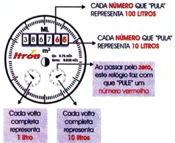
Figura 2 – Mostrador de um hidrômetro Velocimétrico com interpretação da leitura http://www.vlcomercio.com.br/economia-de-agua.html/ Acesso em: 18/09/2017
