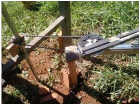
Figura 7 – Transmissão conectada ao eixo por corrente de bicicleta
