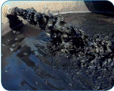
O lodo acumulado em tanques sépticos, proveniente então de um processo anaeróbio, caracteriza-se por possuir uma mistura rica em matéria orgânica (>70%), inorgânica, nutrientes, micro-organismos e mais de 95% de água. Por suas características anaeróbias pode apresentar um odor desagradável.
