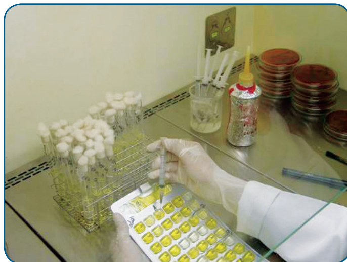
Figura 4 – Coleta de amostras positivas para Escherichia coli nos poços de cartelas com reação MUG positiva.
