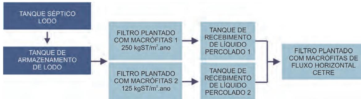
**Figura 1** - Representação esquemática do arranjo implantado na Linha experimental1 – sub-linha1.
