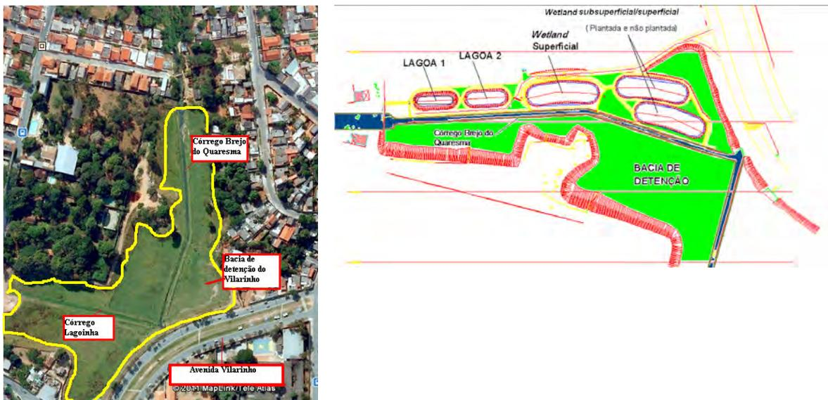
**Figura 6** - Bacia de detenção do Vilarinho e ilustração do sistema de tratamento instalado para tratamento das águas do córrego Brejo do Quaresma
