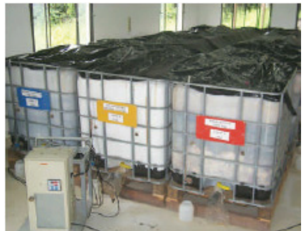
Figura 35 – Reatores cobertos para forçar anaerobiose e acabar com os vermes
