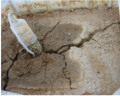
Figura 32 – Superfície ressecada e rachada de um dos reatores, devido à baixa taxa de precipitação no período
