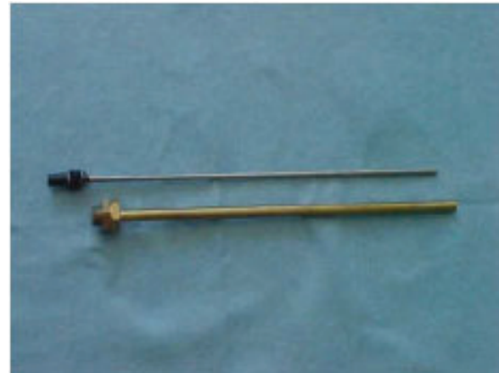
Figura 20 – Dispositivo (poço) para inserir as termorresistências durante o monitoramento da temperatura dentro dos reatores
