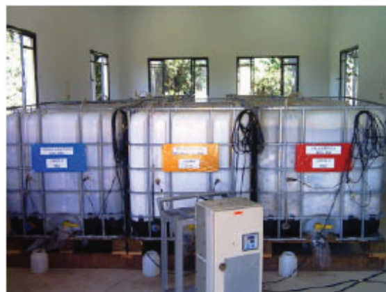
Figura 21 – Reatores preenchidos com os resíduos e sistema de monitoramento da temperatura de dentro dos reatores
