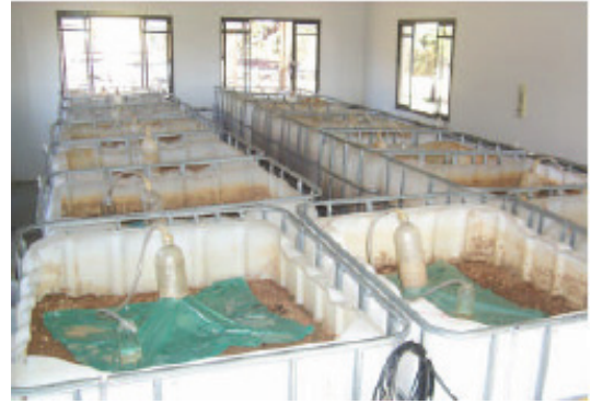
Figura 33 – Superfície do reator coberta, para minimizar a saída de gases e a entrada de oxigênio atmosférico
