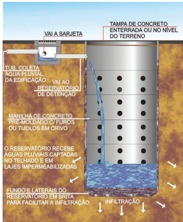
Figura 4.3 – Poço de infiltração
