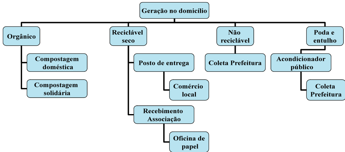
Figura 3 - Esquema do gerenciamento dos resíduos sólidos implantado no Arraial de São Francisco da Mombaça/BA
