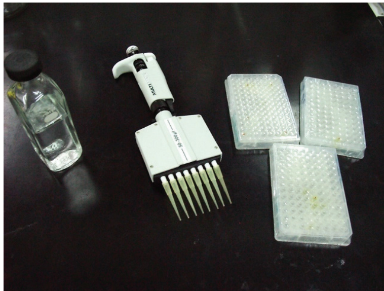
Figura 2C – Sistema de avaliação simplificada de coliformes totais e Escherichia coli em microplacas. Da esquerda para a direita: frasco de amostra de água (100 mL), micropipeta multicanal (8) e microplacas de 96 poços
