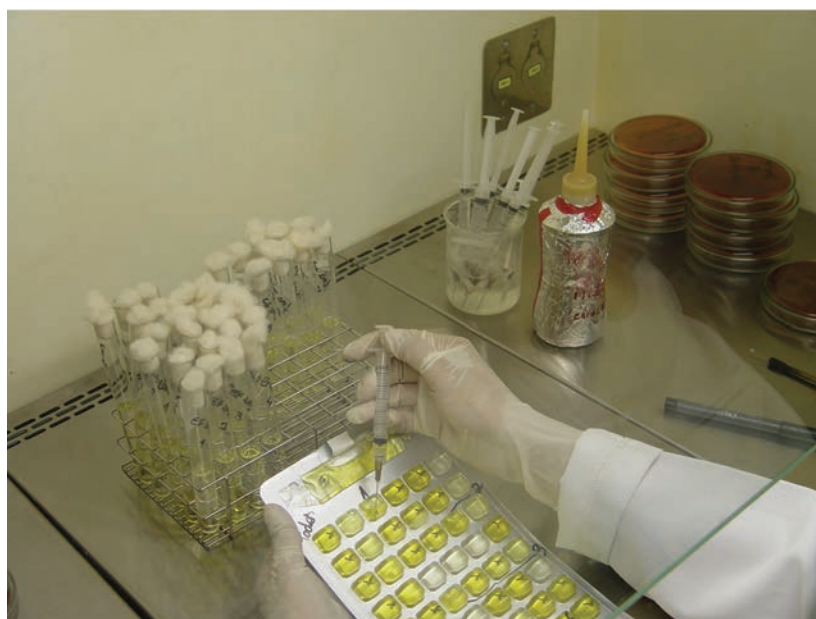
Figura 1B – Coleta de amostras positivas para Escherichia coli nos poços de cartelas com reação MUG positiva
