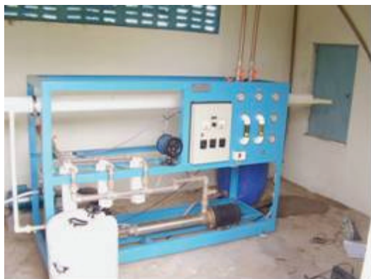
Figura 4 – Dessalinizador de Aroeira: (a) vista do equipamento (b) vista do chafariz automático
