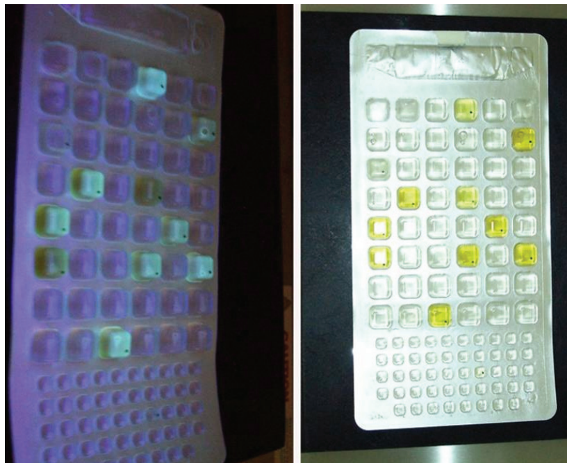
Figura 1B – Coleta de amostras positivas para Escherichia coli nos poços de cartelas com reação MUG positiva
