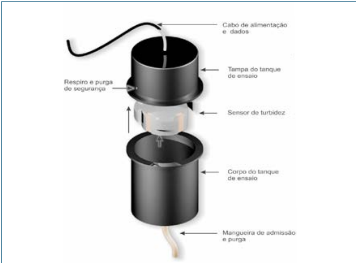
Figura 11 – Estrutura do sensor ótico desenvolvido.
