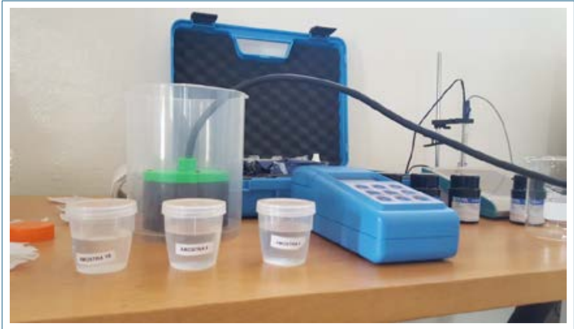
Figura 12 – Arranjo experimental para teste de calibração do sensor de turbidez e cor.
