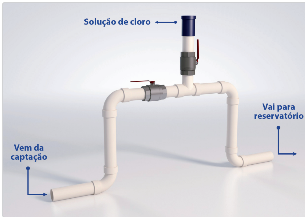
Figura 4 – Esquema do clorador instalado na tubulação.
