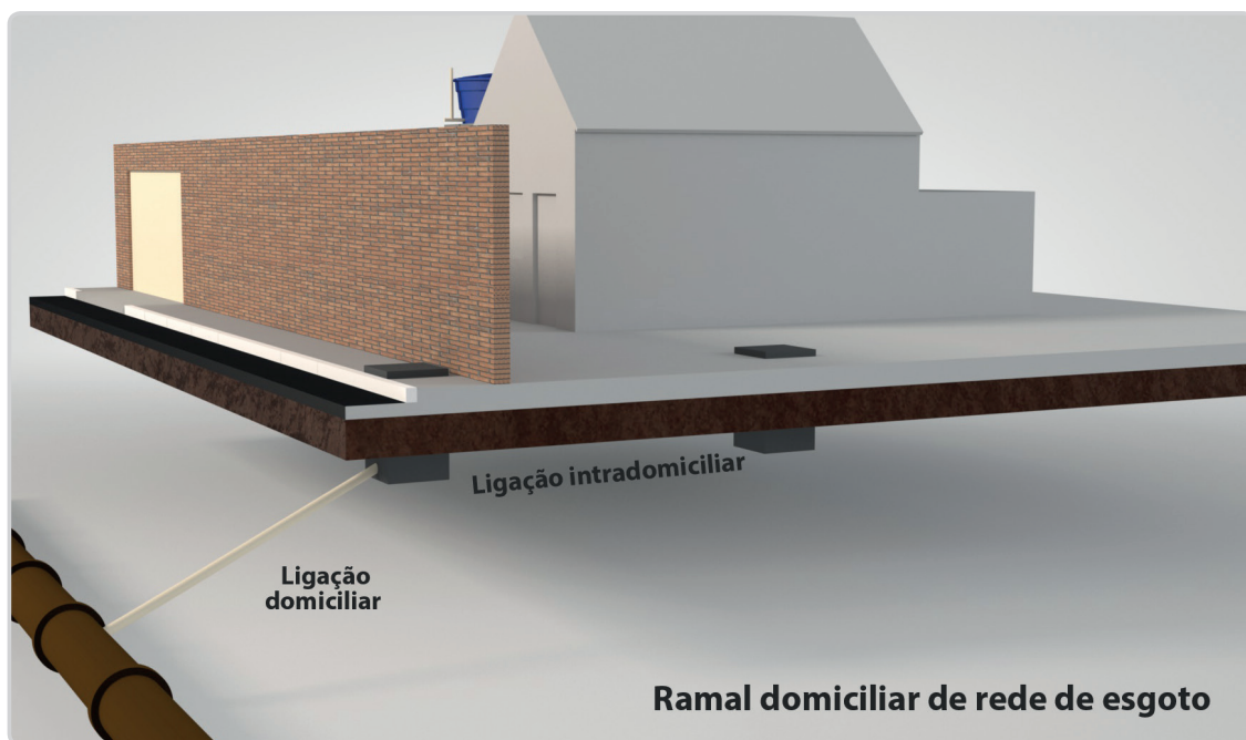
Figura 15 – Esquema da ligação domiciliar de esgoto.
