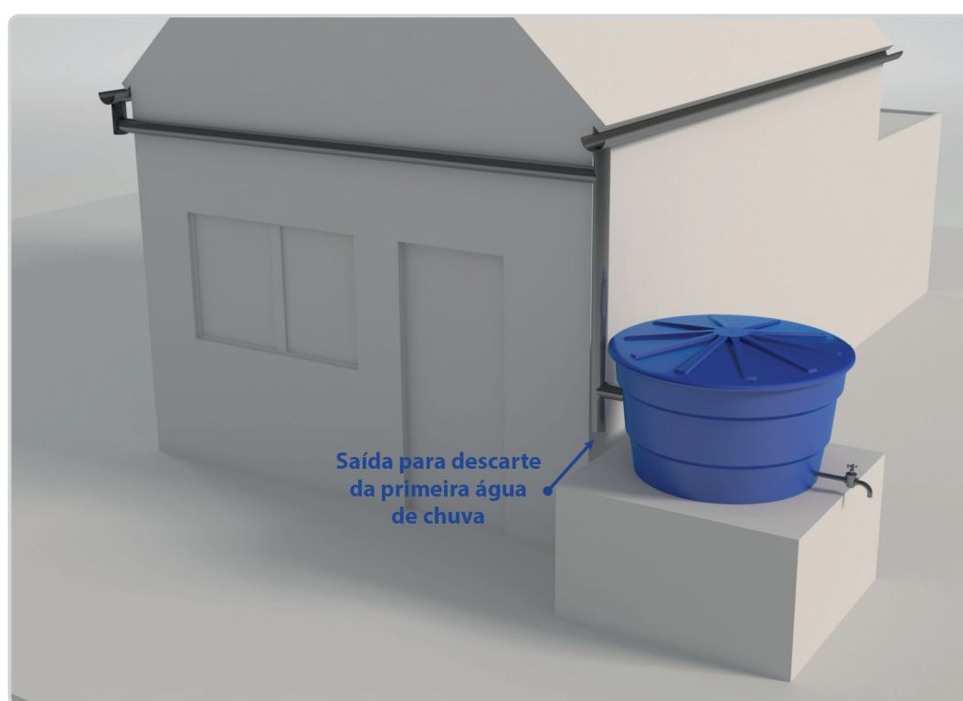
Figura 7 – Reservatório para pequenos volumes.
