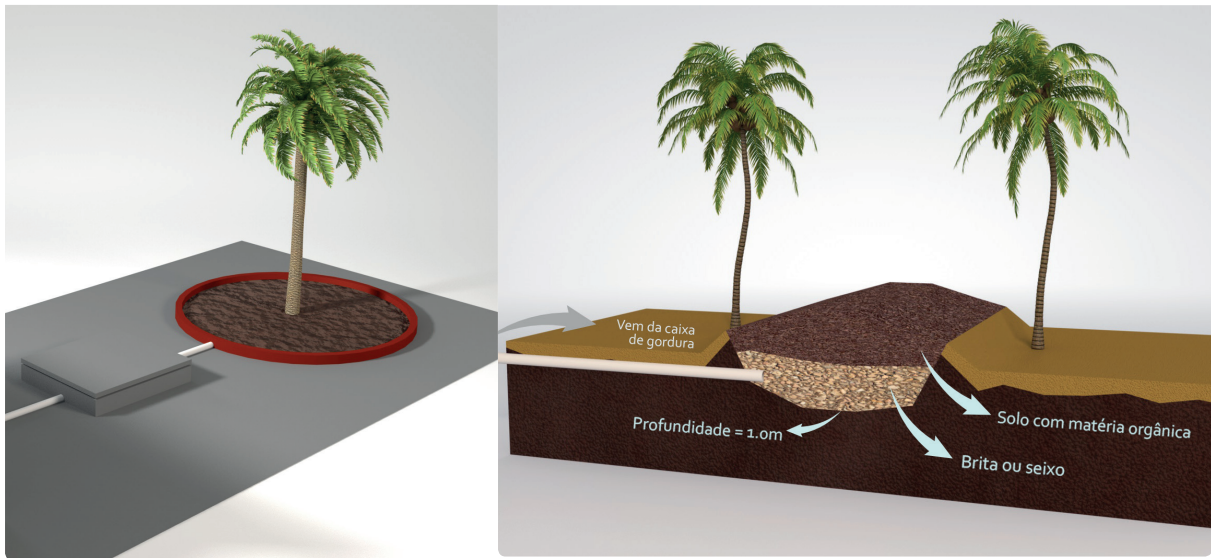
Figura 22 – Círculo de bananeiras para efluente de pia de cozinha.
