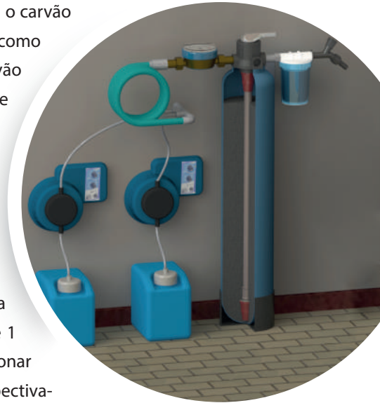
Figura 2. Sistema de desfluoretação por precipitação por contato.
