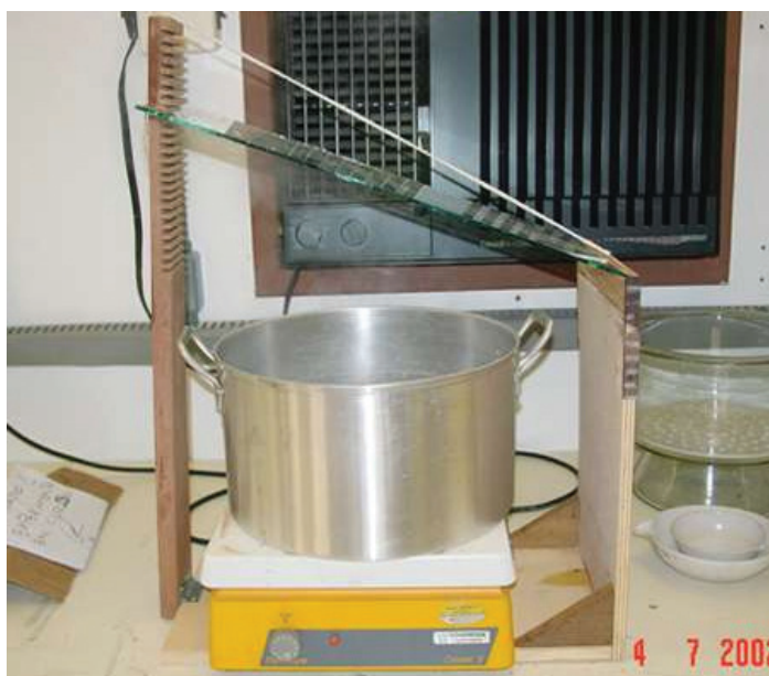
Figura 1. Foto do equipamento para testar as inclinações da cobertura
