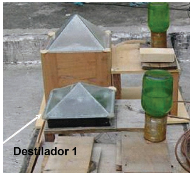
Figura 6. Foto do equipamento de tratamento de água tipo 1
