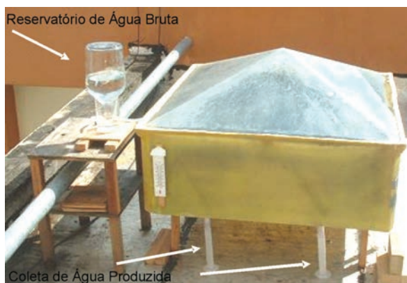
Figura 9. Foto do equipamento otimizado com reservatório acoplado de água produzida
