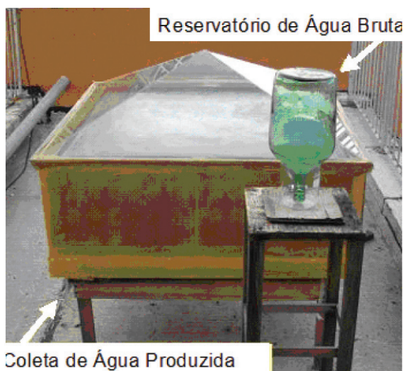
Figura 9. Foto do equipamento otimizado com reservatório acoplado de água produzida
