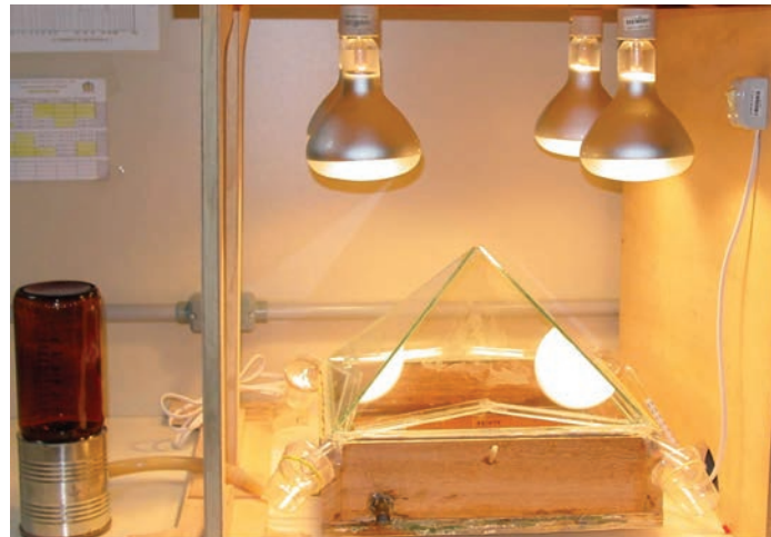
Figura 4. Foto do equipamento com base de madeira para testar a melhor lâmina d'água
