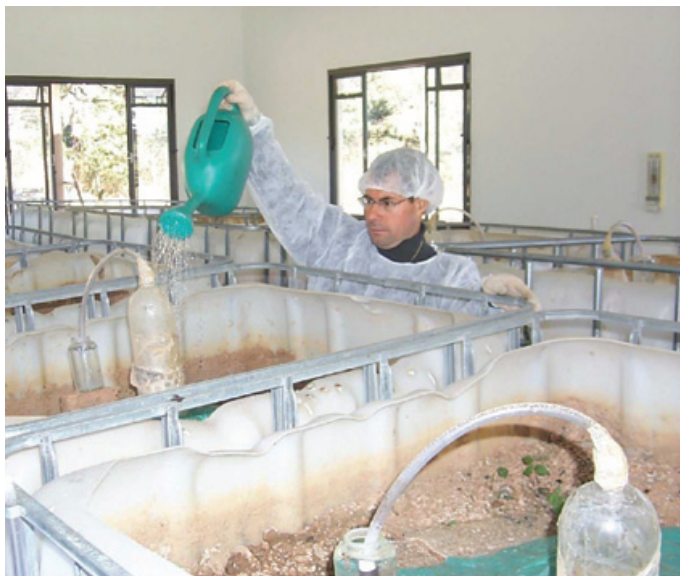
Figura 2 – Aplicação de chuva simulada.
