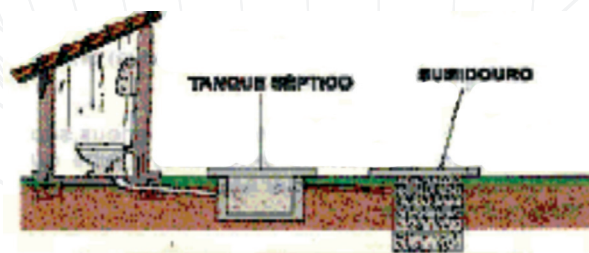
Fig. 03 – Fossa séptica e sumidouro com pneus usados.
