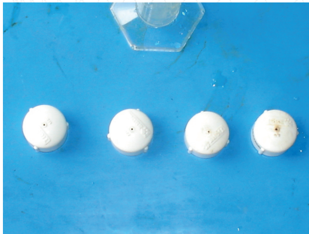
Figura 3. Orifícios críticos criados para a fase de testes com o protótipo.
