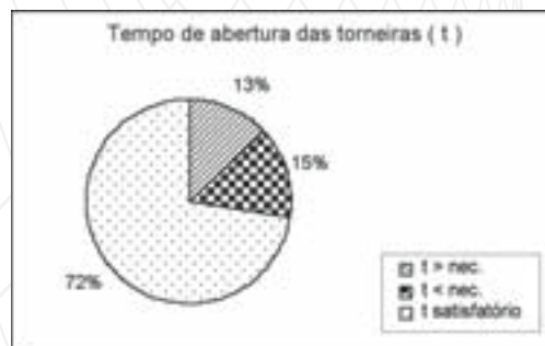
Figura 1 - Avaliação do tempo de abertura das torneiras hidromecânicas.
