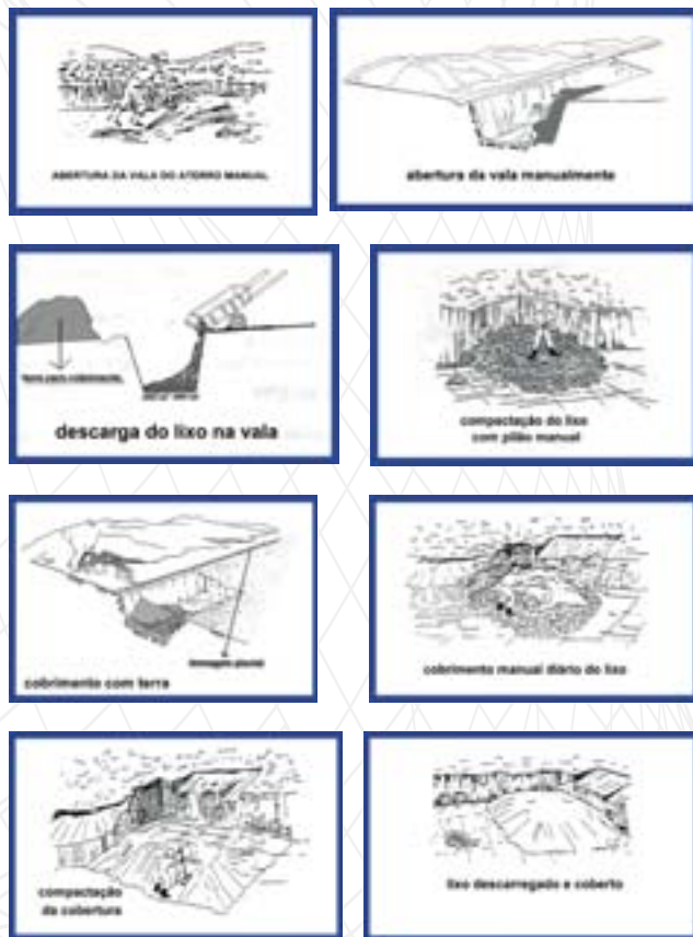
Figura 5 Esquema das valas sanitárias
