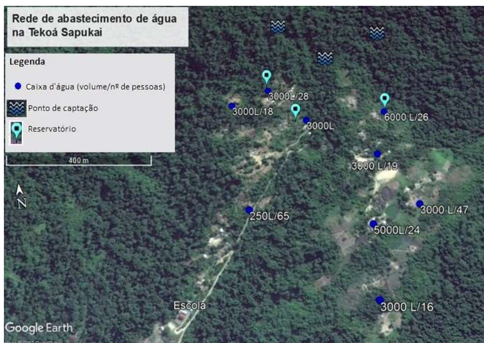
Figura 7 – Sistema de abastecimento de água na Tekoá Sapukai
