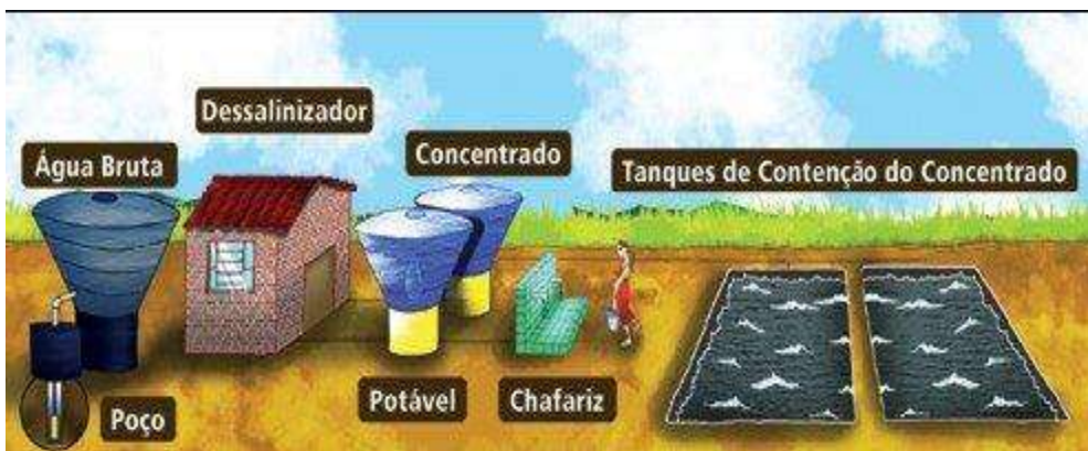
Figura 2.16 Sistema geral de Dessalinização do Programa Água Doce
