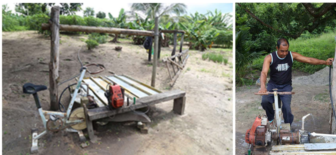
Figura 37 – a) Captação de água do poço, realizada por equipamento desenvolvido por morador; b) Morador demonstrando como utiliza sua invenção
